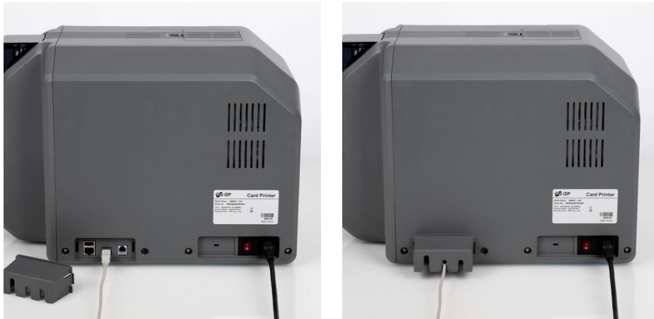
그림 7 SMART-81 전원 및 통신포트 연결
