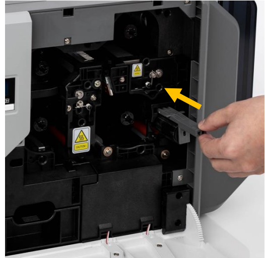
그림 15 클리닝 롤러 카트리지 장착
